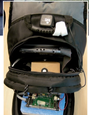
LE SYSTÈME DE GÉOLOCALISATION DÉVELOPPÉ PAR LE LAAS FUSIONNE LES INFORMATIONS ISSUES D'UN CAPTEUR GPS STANDARD ET DES MEMS 1 DISPOSÉS DANS UN BOÎTIER FIXÉ À LA TAILLE DU SUJET
