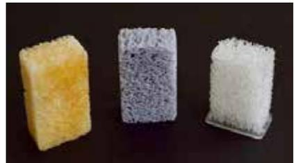
*Supports imitant la structure 3D et poreuse de l'os*
