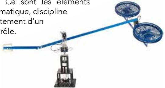
Notre plateforme permet d'illustrer la différence entre la commande en boucle ouverte (on agit directement sur les actionneurs, comme par exemple quand l'humain agit sur la pédale d'accélération dans une voiture) et la commande en boucle fermée (le régulateur de vitesse pour le cas de la voiture). Elle vous permettra ainsi de voir ce qui se cache dans un contrôleur d'un point de vue mathématique et informatique.
