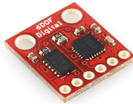
Figure 8 : Exemple de centrale à inertie
