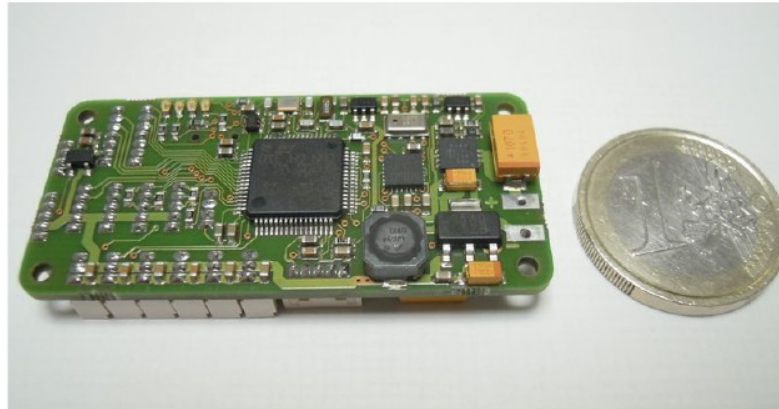
Figure 4 : Apogee, une carte d'autopilote du projet Paparazzi
