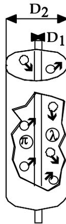
Manomètre thermique - Conduction thermique
