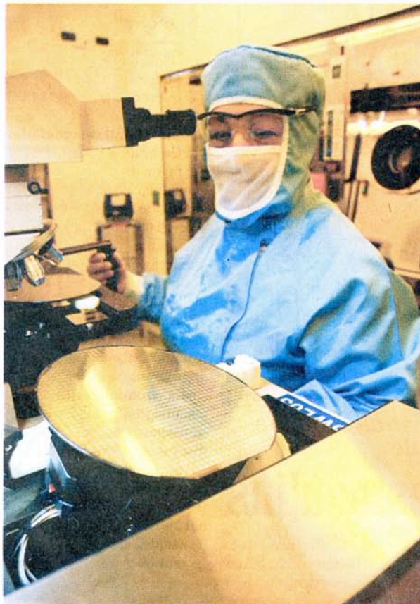
La fabrication de puces sur plaquette de silicium en salle blanche de classe 1. Photo DDM, Adrien Duquesnel.
