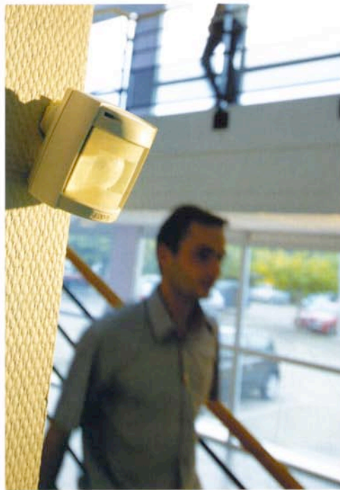
Des réseaux de capteurs, communiquant entre eux, mémoriseront nos comportements et assureront notre confort autant que notre sécurité. Ici, un capteur de mouvement infrarouge.
