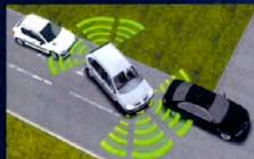
Des capteurs intégrés aux pare-chocs vous aident à vous garer.
