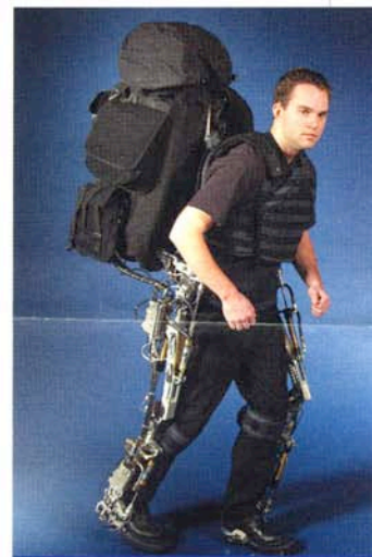
Exosquelette développé à l'Université de Berkeley (Californie, USA) dans le cadre du projet BLEEX (Berkeley Lower Extremity EXoskeleton). (© Berkeley Robotics and Human Engineering Laboratory)
