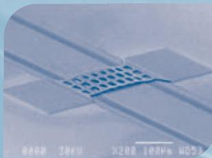
Les dépôts électrochimiques d'au, Cu, CoFeNi, Pb de quelques microns à plusieurs centaines de microns d'épaisseur trouvent leur application dans la réalisation d'inductances pour la conversion d'énergie et de tous les dispositifs hyperfréquences. Ces moyens sont complétés par des postes de nettoyage RCA, de chimie, et des sorbonnes.
