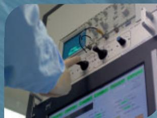
Un implanteur ionique moyen courant, d'une tension d'accélération maximale de 200 KV permet le dopage des matériaux hors équilibre thermodynamique, et avec masquage.
