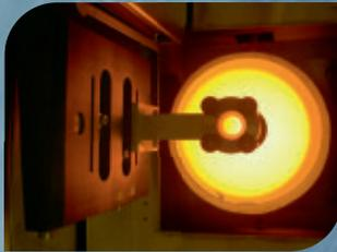
22 réacteurs permettent les opérations d'oxydation et de diffusion, les croissances ou dépôts LPCVD et PECVD de nitrures, Silicium polycristallin, le recuit des métaux, polyimides, matériaux III-V par procédés classiques ou rapides.
