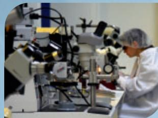
Près d'une trentaine d'équipements couvrent tous les aspects de l'assemblage des composants, tant au niveau discret que collectif. Moyens pour la découpe, le report manuel et semi-automatisé, la microsoudure filaire ou par flip chip, l'encapsulation, le polissage mécano chimique, l'amincissement et la soudure des plaquettes.
