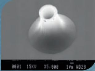
Réalisation de plus de 400 niveaux de masques par an à l'aide de moyens de CAO et d'un équipement de lithographie haute résolution par écriture laser. Dispositif d'alignement utile à l'écriture directe sur substrats pour le prototypage avec une tolérance de 0.2 à 1µm. Création de structures complexes en 3D par niveaux de gris.
