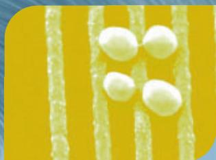
À partir d'un dessin par CAO le faisceau d'électrons convergent du masqueur électronique suit une trajectoire pour insoler une résine électro sensible avec une résolution de 20 nm sur les résines positives et de 50nm sur les résines négatives. Les moyens sont complétés par un bâti de dépôts et une presse pour la réplification des motifs.
