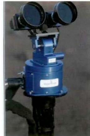
*Système de vision du prototype du rover Exomars.*
