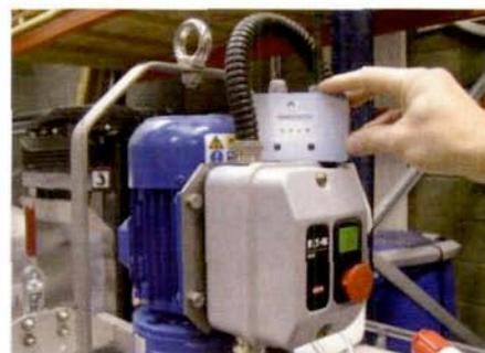
**Pétrochimie.** Avec les capteurs sans fil développés par Nova Mems, il est possible de surveiller la température d'appareils placés dans des zones explosives.
