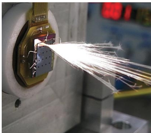
Caractérisation en poussée : photo de la balance et exemple de résultats de poussée obtenu
