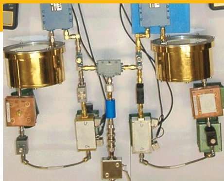
Caractérisation par battement de fréquence de deux sources saphir-TBH SiGe à 4.85 GHz. Le niveau (effectivement mesuré) de bruit de phase est de -138 dBc/Hz à 1 kHz de la porteuse
