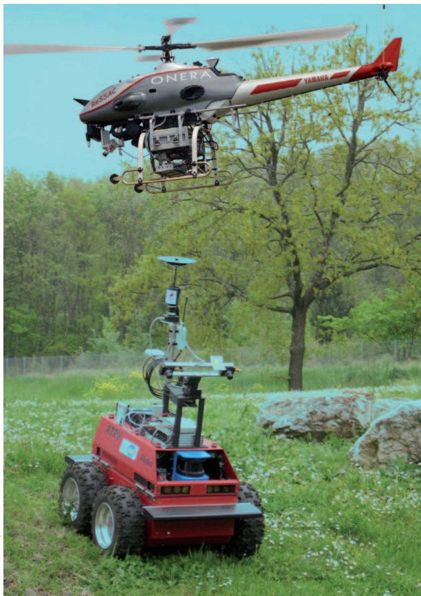
PERCEPTION COORDONNÉE ENTRE ENGIN TERRESTRE ET AÉRIEN : LES ROBOTS DALA, DU LAAS, ET RESSAC, DE L'ONERA (PHOTOMONTAGE)
