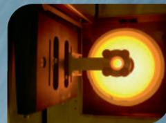
22 réacteurs permettent les opérations d'oxydation et de diffusion, les croissances ou dépôts LPCVD et PECVD de nitrure, Silicium polycristallin, le recuit des métaux, polyimides, matériaux III-V par procédés classiques ou rapides.
