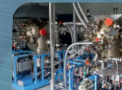
Deux réacteurs d'Épitaxie par Jet Moléculaire RIBER 2300 et 32P permettent la croissance de structures complexes de matériaux III-V. Les principaux champs d'application sont la réalisation de diodes laser à ruban, à cristal photonique, de VCSELs.
