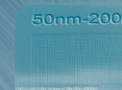
Objet de nombreuses études la nano impression UV permet de répliquer à grande échelle des structures nanométriques générées en lithographie électronique. L'outil actuellement disponible sur un aligneur de masques sera prochainement renforcé par un équipement dédié.
