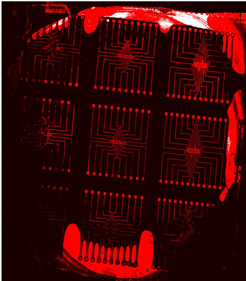
*Image obtenue par des étudiants au cours de l'atelier, représentant des motifs micrométriques de molécules d'ADN fluorescentes imprimés par lithographie douce sur des substrats de Silicium.*
