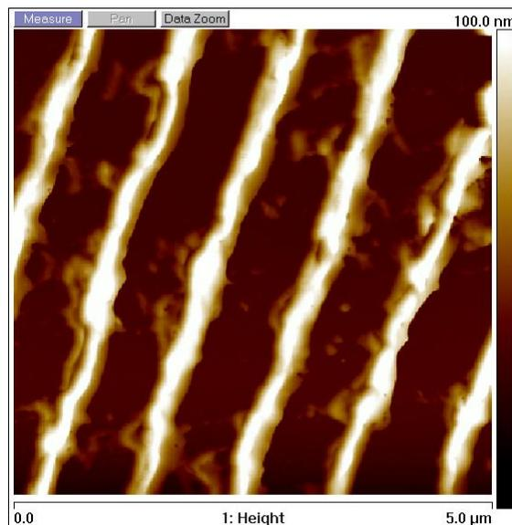
*Image obtenue par des étudiants au cours de l'atelier, représentant des motifs nanométriques de dendrimères imprimés par soft-lithography. La largeur des lignes est de 150 nm.*
