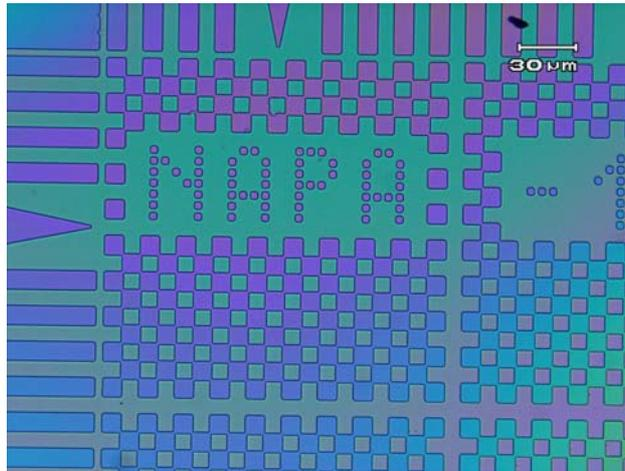
*Image obtenue par des étudiants au cours de l'atelier, représentant des motifs micrométriques imprimés par NIL à l'aide d'un moule fabriqué au sein du projet Européen NAPA.*
