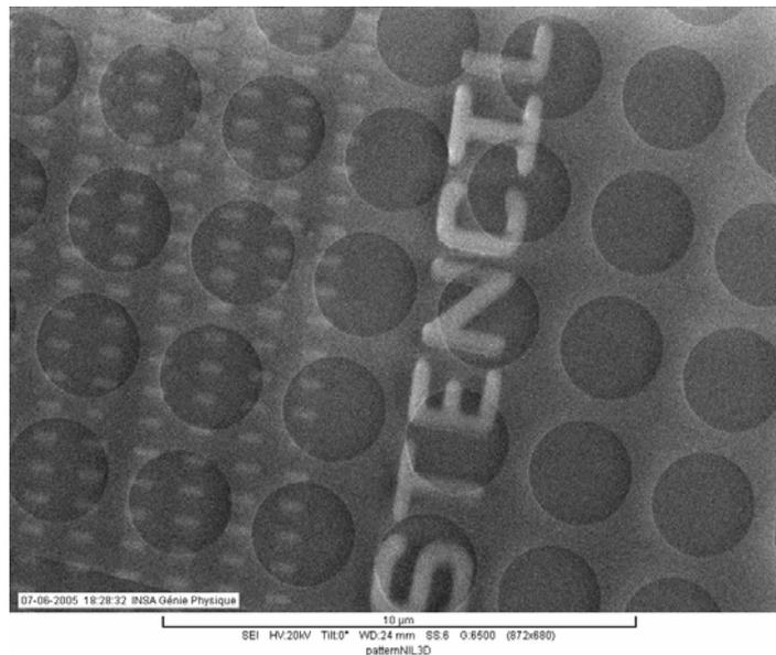
*Image obtenue par des étudiants au cours de l'atelier, représentant des motifs nanométriques déposés par « stencil lithography » sur une couche de résine préalablement structurée par NIL. . La largeur des plus petites lignes est de 150 nm.*
