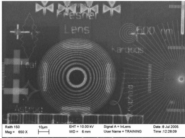
*Image obtenue par des étudiants au cours de l'atelier, représentant des motifs nanométriques obtenus par lithographie électronique sur une couche de résine PMMA . La largeur des plus petites lignes est de 25 nm.*
