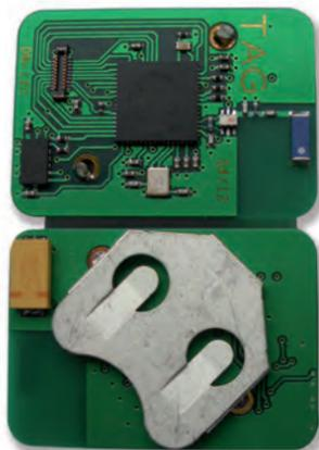
Tag avec technologie Zigbee.
