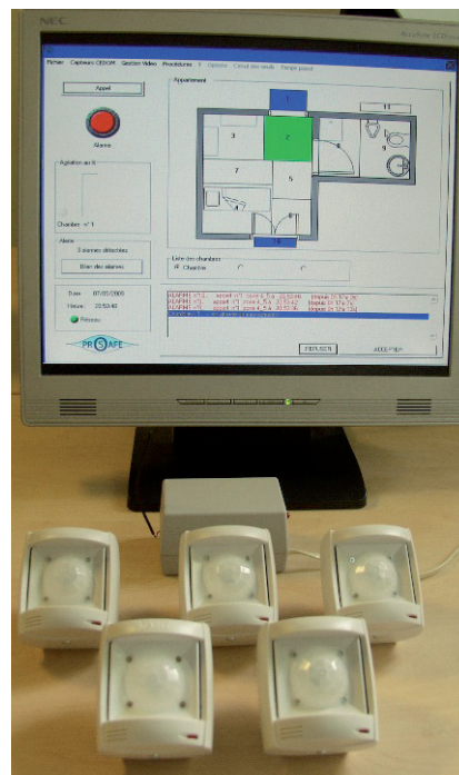
RÉSEAU DE CAPTEURS DE PRÉSENCE SANS FIL NON INTRUSIF ET INTERFACE DE CONTRÔLE ET DE COMMANDE SUR ORDINATEUR POUR LE PERSONNEL MÉDICAL
