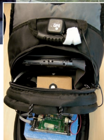
LE SYSTÈME DE GÉOLOCALISATION DÉVELOPPÉ PAR LE LAAS FUSIONNE LES INFORMATIONS ISSUES D'UN CAPTEUR GPS STANDARD ET DES MEMS 1 DISPOSÉS DANS UN BOÎTIER FIXÉ À LA TAILLE DU SUJET
